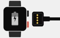
Legen Sie die Armbanduhr, wie in der Abbildung ersichtlich, auf die Ladekontakte und laden Sie die Uhr für mindestens eine Stunde. Stellen Sie sicher, dass die Goldstifte auf der Rückseite der Uhr den Stecker berühren.
