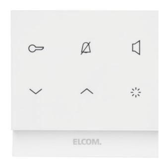
Audio Innenstation zum Freisprechen für Sprechanlage nach DIN EN 50486 in 2Draht-Technik. Innenstation zur Wandmontage oder auf eine Gerätedose nach DIN 49073. Bestehend aus Tragplatte mit Anschluss-Klemmblock und passenden Audio-Designrahmen, mit 6 Symbolen und kapazitiven Funktionstasten mit taktiler Rückmeldung, davon 3 Tasten hinterleuchtet (Öffnen, Stummschaltung und Gespräch annehmen).
