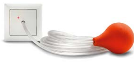
Pneumatischer Ruftaster mit pneumatischem Schaltelement. Auslösung durch Druck auf roten Gummiball an 2 m langem Klarsicht-Kunststoffschlauch
