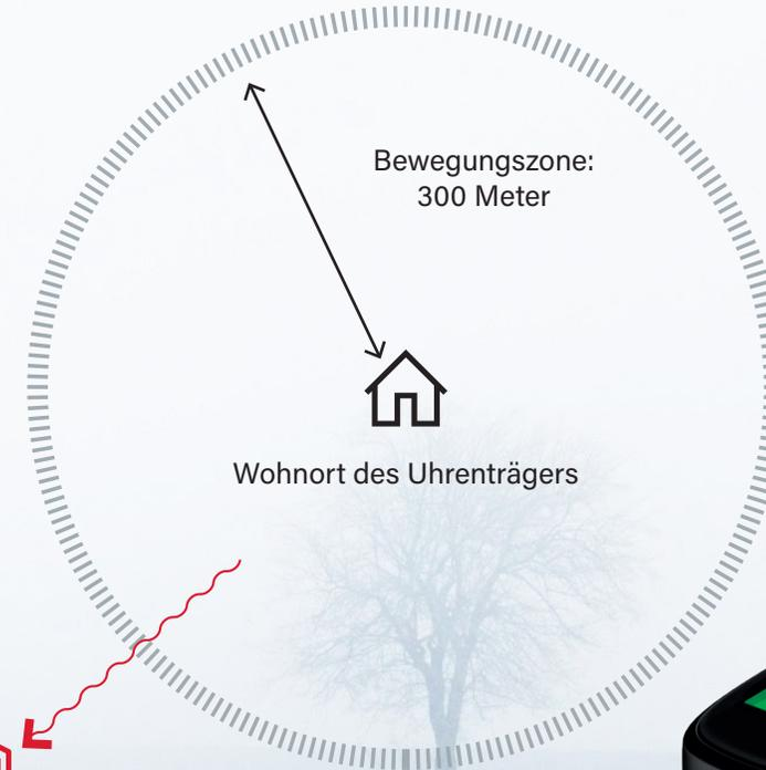
Passive Alarmierung beim Verlassen der Bewegungszone. Die exakte Position wird mit GPS ermittelt, um die betroffene Person schnellstmöglich zu finden.
